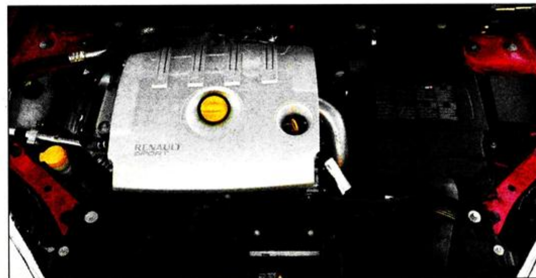
Die Mégane RS het 'n tweeliter-turbo-enjin wat 184 kW teen 5 500 r/min. en 340 Nm wringkrag teen 3 000 r/min. lewer.
